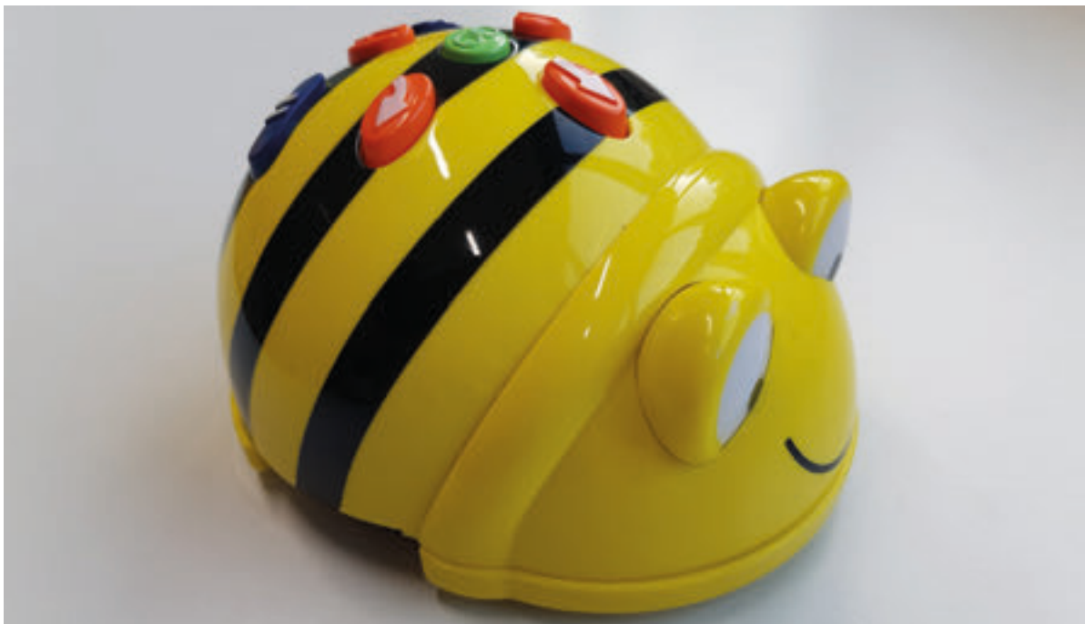
Der „BeeBot“ ist ein Bodenroboter in Form einer Biene, der Vorwärts- und Rückwärtsbewegungen sowie Rechts- und Linksdrehungen ausführen kann
